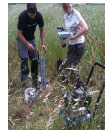
Test de résistance à l'arrachage des pieux
