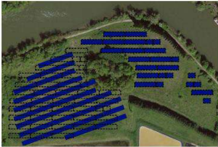
Figure 31 - Réorientation des panneaux photovoltaïques en amont
