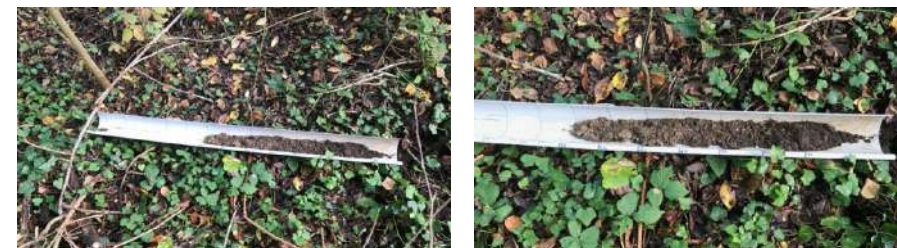
Sur le carottage du point 21, aucune trace d'oxydoréduction jusqu'à 50 cm.
