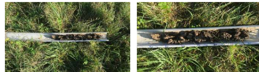
Sur le carottage du point 15, aucune trace d'oxydoréduction jusqu'à 50 cm.
