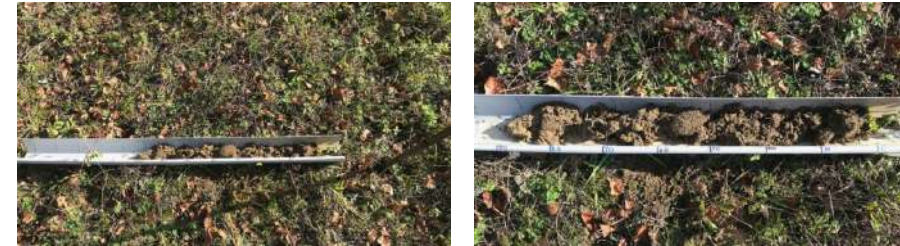
Sur le carottage du point 25, aucune trace d'oxydoréduction jusqu'à 50 cm.
