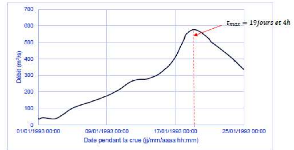
Figure 13 – Temps du pic de crue centennale sur l'Aisne en amont de la zone d'étude
